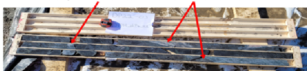
DRILLHOLE DP22-03 118.5 – 121.5 M; 3 m @ 151.65 g/t Au
